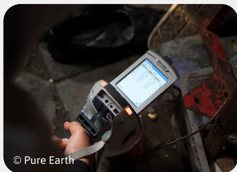
Gambar 7. Alat X-Ray Fluorescence Portabel untuk mengukur kadar timbal pada produk dan sampel lingkungan di sekitar rumah
